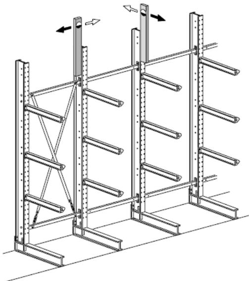
Horizontale Niveau-Unterschiede mit Unterlegplatten ausgleichen.
