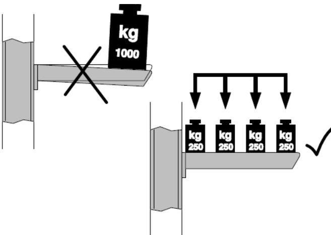
Lasten müssen gleichmäßig auf dem Kragarm verteilt sein. Die angegebenen maximalen Traglasten pro Kragarm gelten für gleichmäßig verteilte Last.
